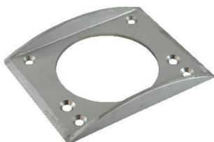
In den Wintermonaten, wenn Schneepflüge beim Ein- und Ausfahren in Tunnels die Leuchtenmodule touchieren, sind abgescherte Einheiten und somit deren Ersatz die Folge. Dem kann man jedoch mit dem Einsatz eines Schutzblechs in V4A-Qualität entgegenwirken. Dabei ist es ausreichend, wenn Sie jeweils die ersten MarkLED i1 beim Tunnel-ein- und ausgang damit ausrüsten.
